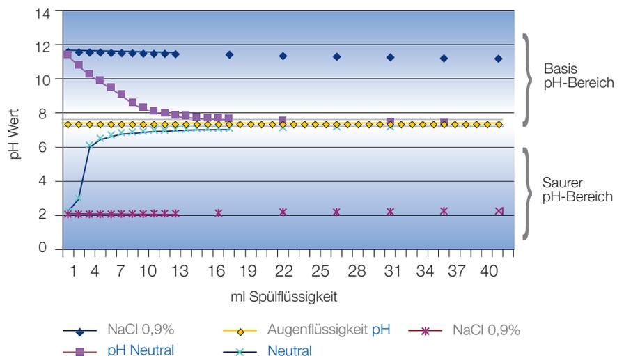
\*Es handelt sich hierbei um eine von Plum A/S durchgeführte Titrationsanalyse im Labor (in vitro Test). Hierbei wurde die Flüssigkeit pH Neutral und 0,9 % Natriumchloridlösung schrittweise einer Lösung mit 1 Tropfen Schwefelsäure + 40 ml Leitungswasser bzw. 1 Tropfen Kaliumhydroxid + 40 ml Leitungswasser zugeführt. Die Änderungen des pH Wertes und die dafür erforderlichen Mengen von Spülflüssigkeit wurden für die Beurteilung des Effektes herangezogen.
